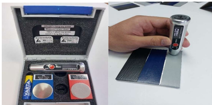
Slika 3 - Mjerni instrument i proces mjerenja debljine premaza.
